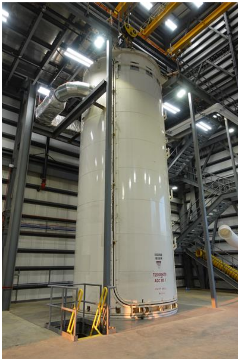
Zainstalowana w zakładach Aerojet Rocketdyne w Camden komora ciśnieniowa wykorzystywana w procesie technologicznym budowy silników SRM. Fot. Aerojet Rocketdyne [aerjetrocketdyne.com]
