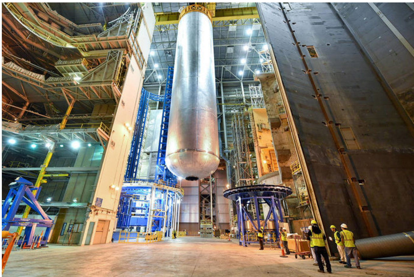
Zbiornik na wodór rakiety Space Launch System, fot. NASA/MAF/Steven Seipel
