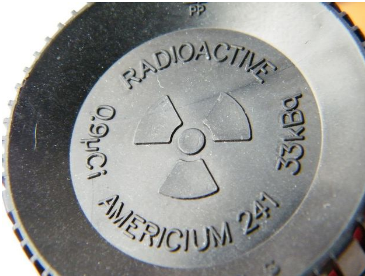
Pojemnik na ameryk-241 w wykrywaczu dymu. Fot. domena publiczna
