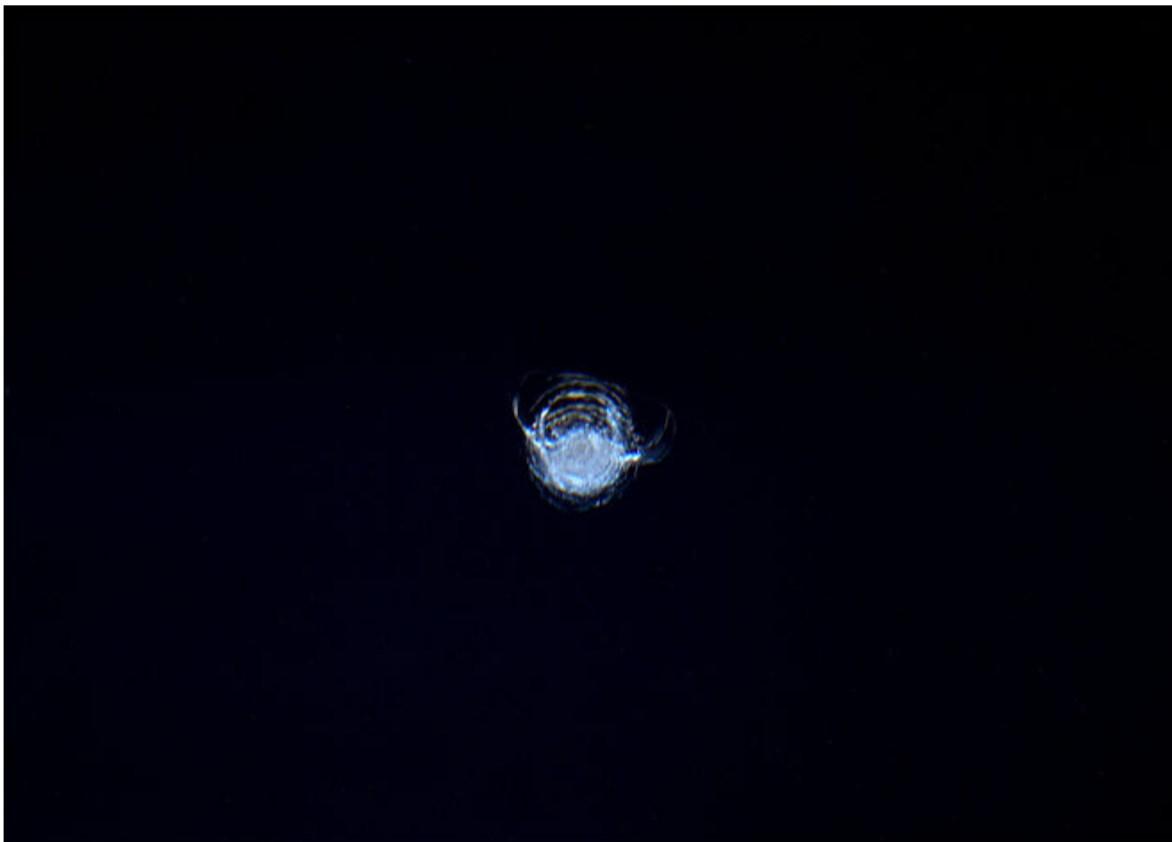
Uszkodzenie szyby ISS, Fot. Tim Peake, ESA/NASA
