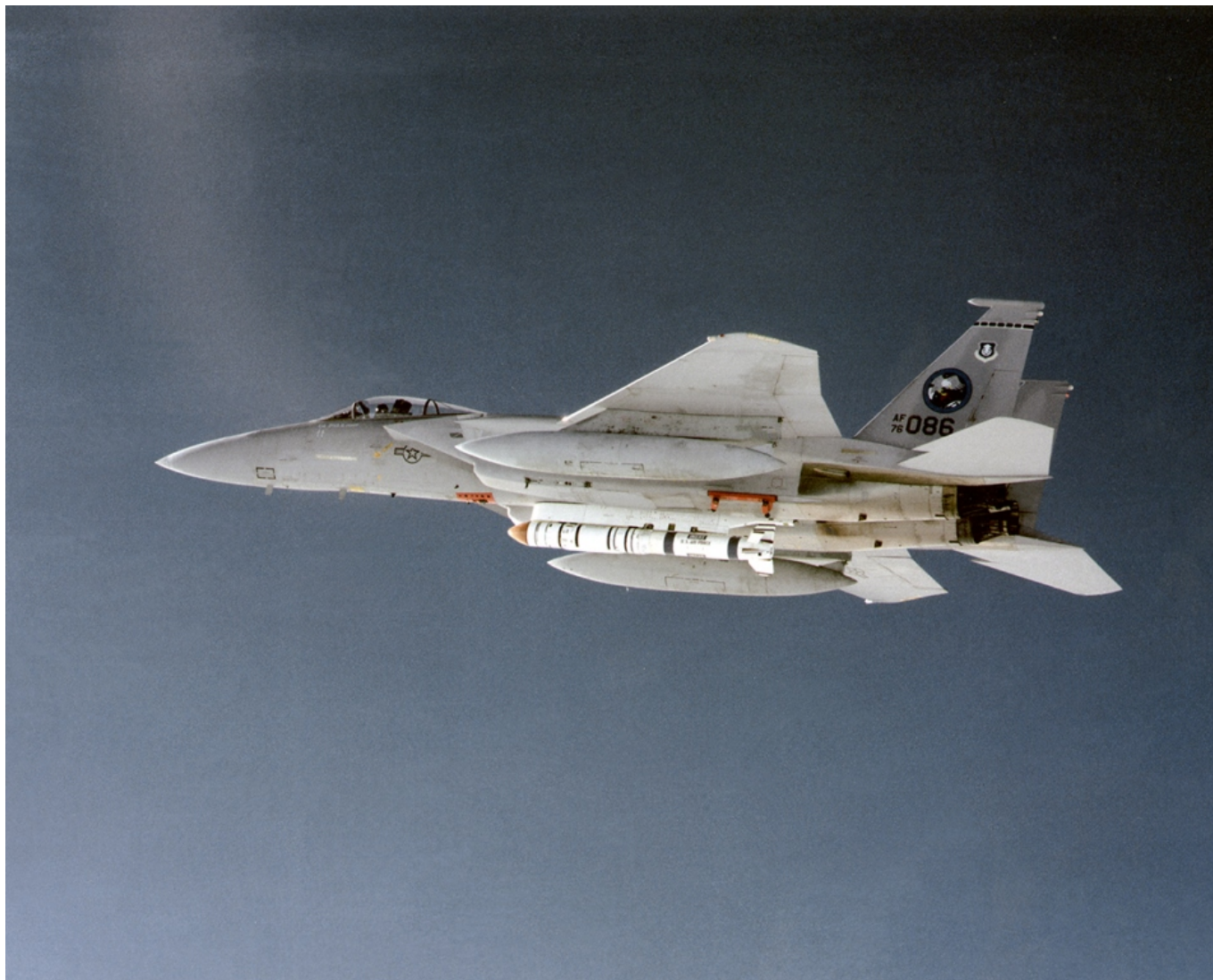
Głównym uzbrojeniem amerykańskiego systemu antysatelitarnego w czasach Zimnej Wojny były rakiety ASM-135, w które wyposażono samoloty F-15. Fot. USAF
