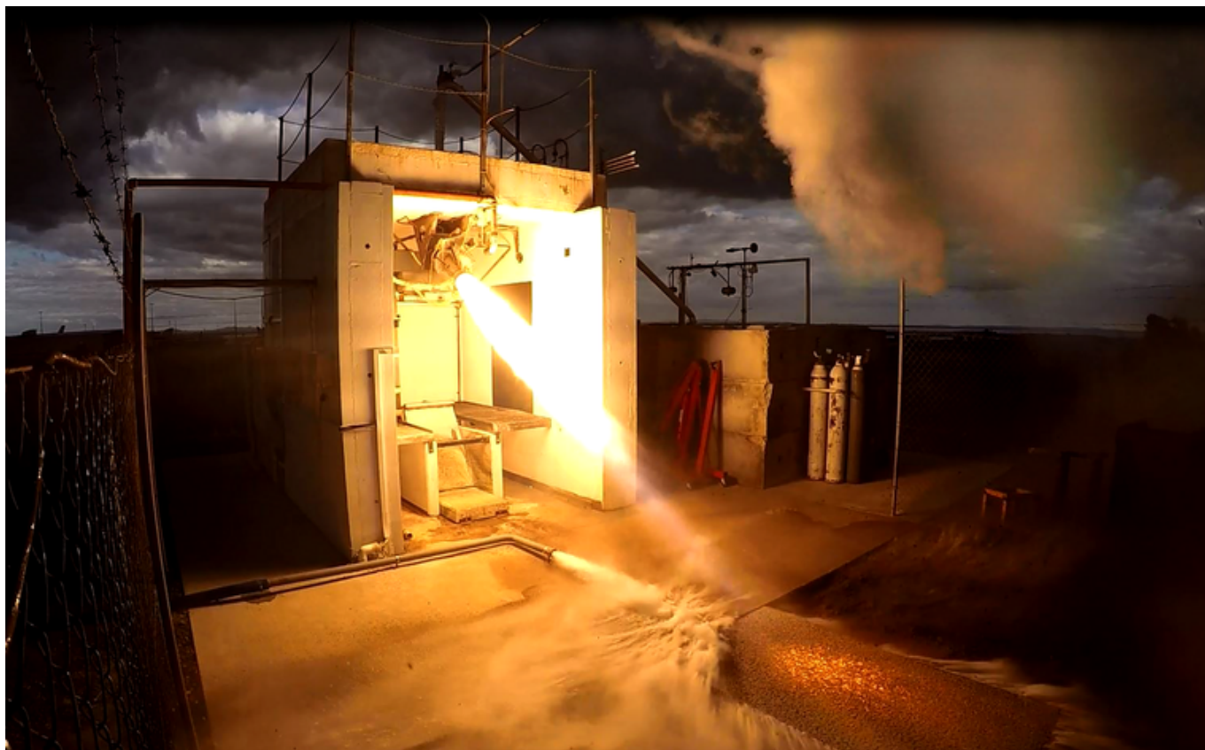
Test silnika Rutherford napędzającego raketę Electron firmy Rocket Lab. Fot. Rocket Lab / rocketlabusa.com
