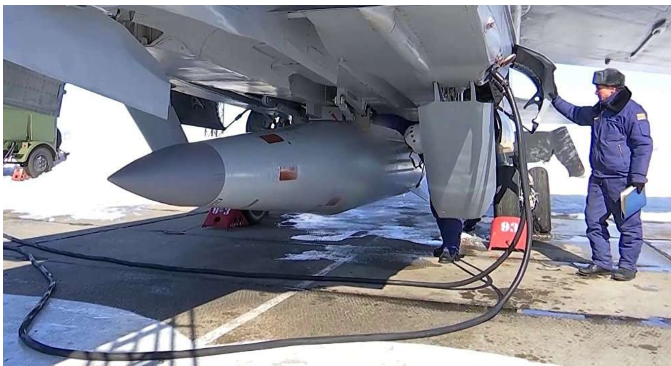
Pocisk hipersoniczny Kindżał w podwieszeniu na węzle uzbrojenia myśliwca MiG-31BM. Fot. Ministerstwo Obrony Federacji Rosyjskiej / mil.ru
